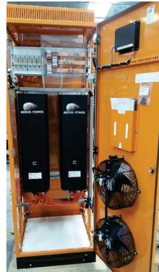
SVG rated 415 V 50/60 Hz +/-288 kvar
